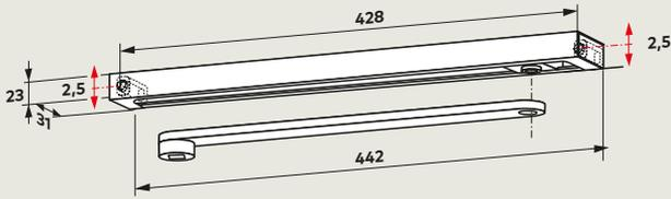
Die Gleitschiene **G-N** umfasst Hebel, Gleitschiene, Gleitstück, Befestigungsstücke, Schrauben und Endkappen. Die Gleitschiene G-N ist sowohl für DIN-L- als auch für DIN-R-Türen verwendbar und kann mit beiden Türschließern kombiniert werden. Durch Langlöcher in den Befestigungsstücken ist es möglich, Abweichungen im Bohrbild auszugleichen und den Abstand zwischen Türschließer und Gleitschiene parallel zu halten.
