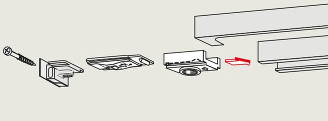
Die Rastfeststelleinheit **RF** ermöglicht ein exaktes Feststellen von Türen ohne Rückfederung bis zu einem Öffnungswinkel von ca. 150°. Die Rastfeststellung lässt sich bei Bedarf vom Benutzer einfach ein- und ausschalten, und die Ausrückkraft kann der jeweiligen Türsituation angepasst werden.
